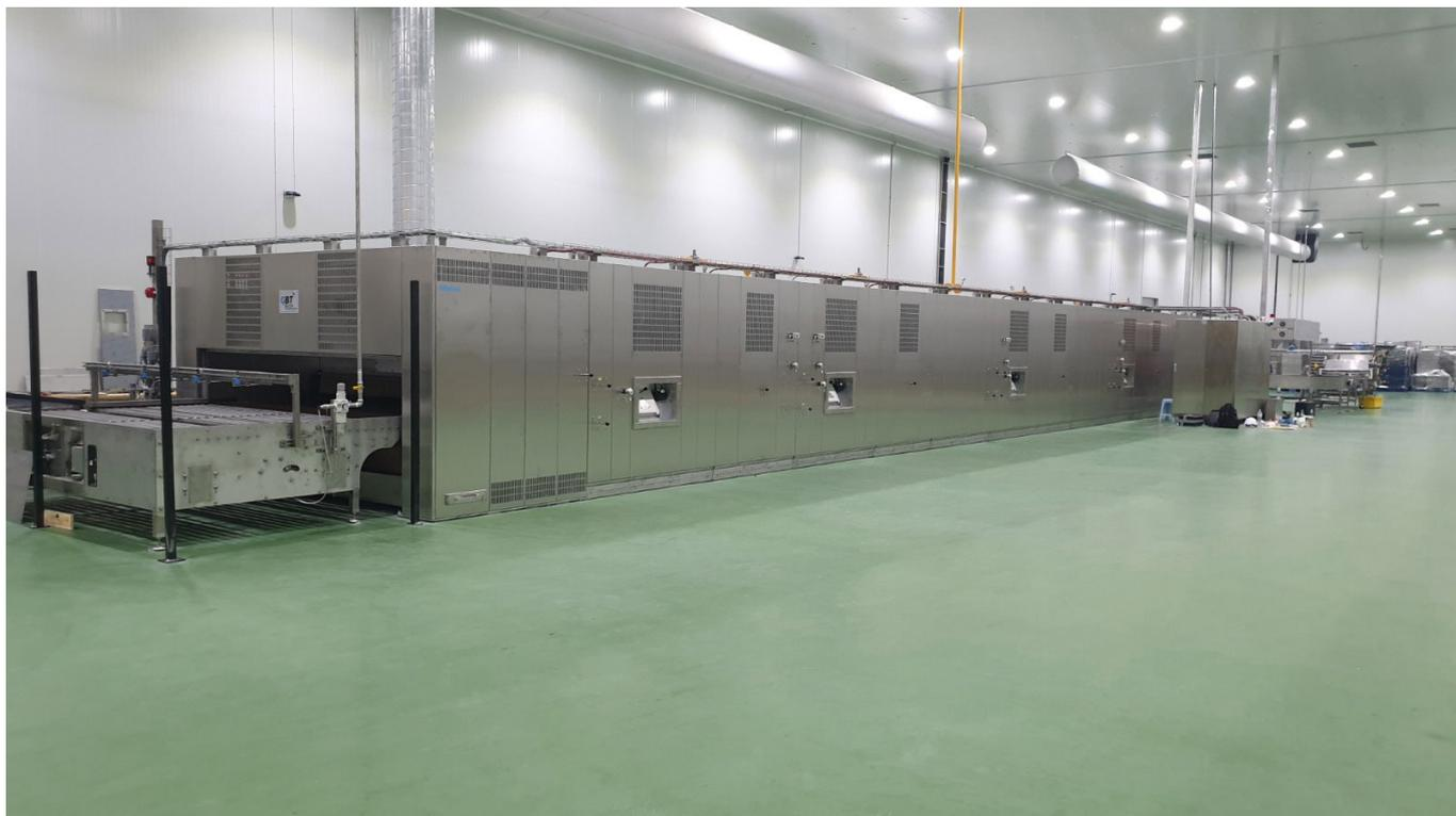
Der neue GBT-Ofen „Mistral“ überzeugt mit gleichmäßiger Wärme vom ersten Backen an. Das Backverhalten ist ähnlich einem Thermoölofen. Mit einer 50 % niedrigeren Anschlussleistung, als die von herkömmlichen Zyklothermöfen, dem Einsatz von konventionellen Haushaltsbrennern für Gas- oder Öleinsatz und der cleveren Modulbauweise mit Rauchgasausnutzung, kann eine Energieeinsparung von bis zu 30 % erreicht werden.
