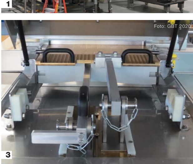
1 Diese Brotanlage besteht aus dem Olympia H2, dem Rundwirker Konus V5000, einem Vorgärschrank mit Palleteinlauf, zwölfreihig und mit 80 Teigträgern, sowie dem Langroller LR6W4B2. 2 Der Vorgärschrank ist komplett mit steckbaren V2A-Blechen verkleidet. Zudem ist er elektrisch abgesichert und verfügt über große verschiebbare Sichtfenster aus Makrolon. 3 Hier sind der Hauptkolben und das Messer des Olympia zu sehen. 4 Die Messkolbeneinsätze sind beliebig einsetzbar. Pumpenkolben und Messer werden mechanisch über eine Kurvenscheibe angetrieben.
